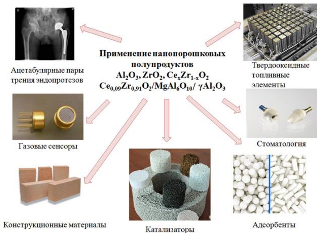
Рис. 1. Области применения нанокompозитов на основе \text{Al}_2\text{O}_3, \text{CeO}_2, \text{ZrO}_2, \text{Ce}_x\text{Zr}_{1-x}\text{O}_2 .
