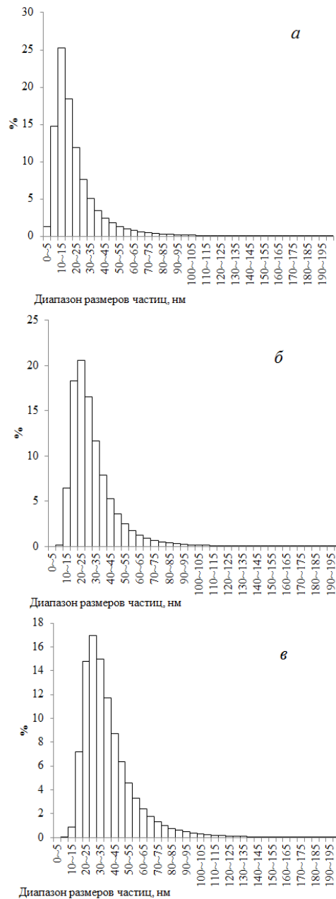
Рис. 61. Распределение частиц по размерам, по данным ДАС, для нанопорошков Al_2O_3 №№: 2 (а), 9 (б) и 10 (в) (нумерация Таблицы 5).
